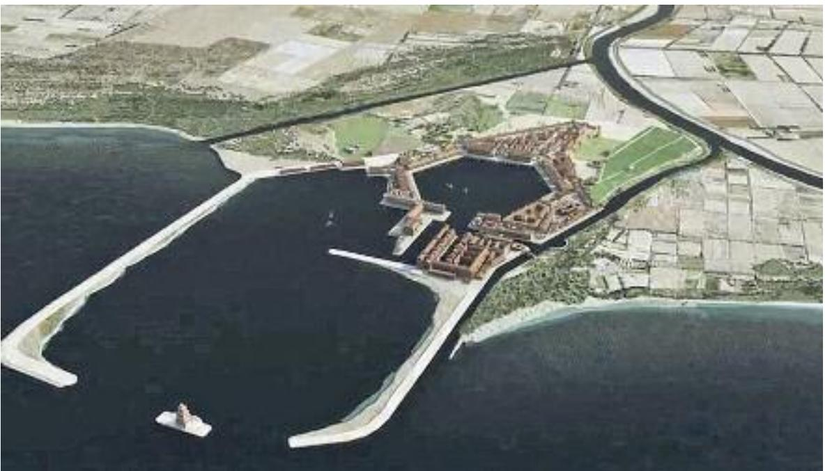
Ricostruzione del sistema portuale nel momento di massimo splendore (secondo-terzo secolo d.C.). In evidenza il bacino esagonale per le operazioni di carico e scarico collegato al Tevere tramite un sistema di canali
